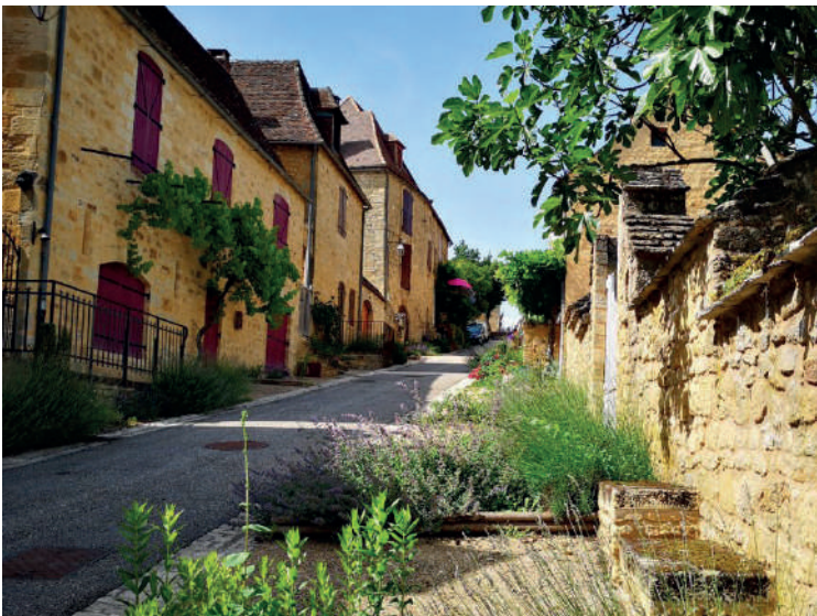
Référence rue partagée en pente avec caniveau latéral Les rives habitées sont traitées en pallier pour créer des seuils.
