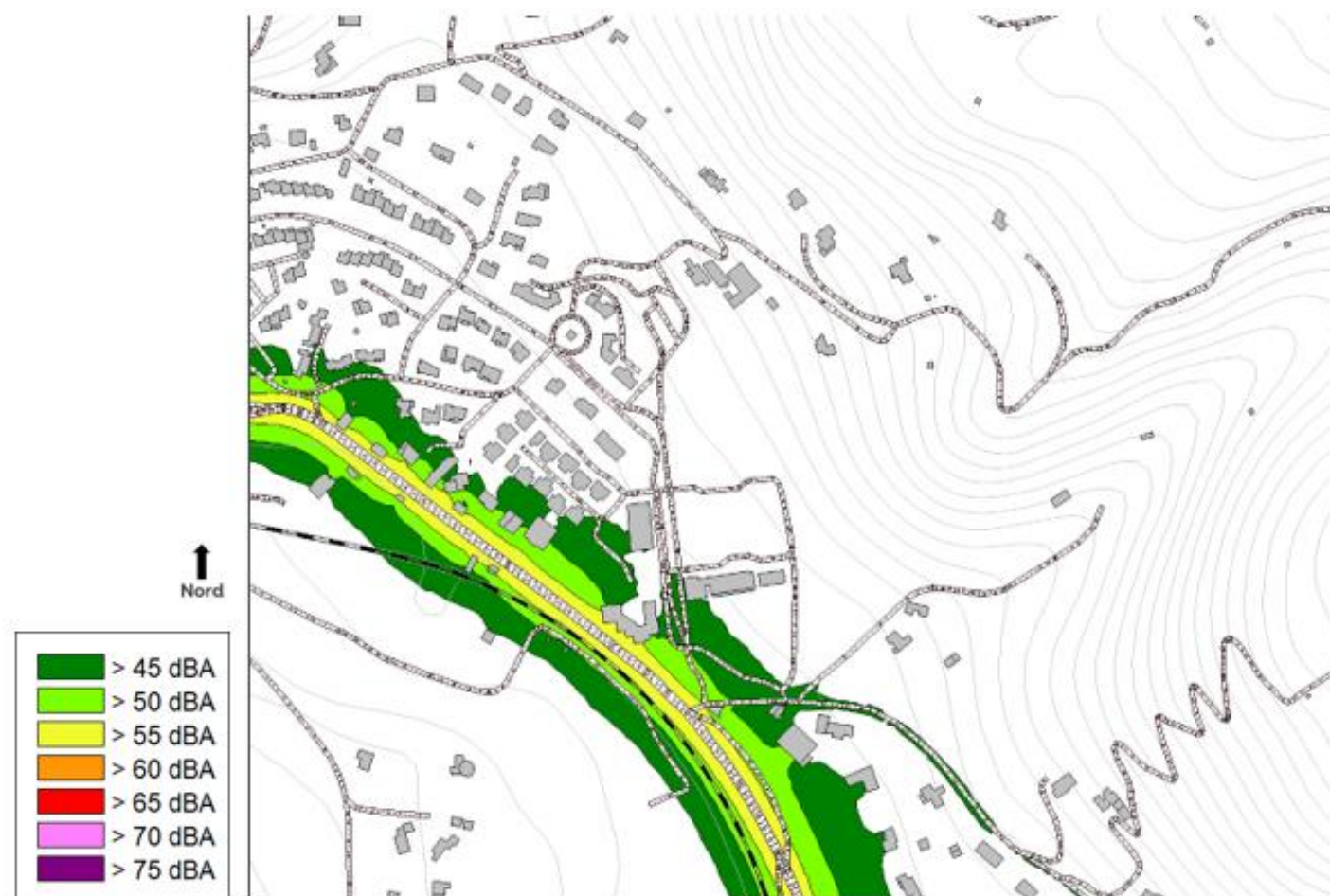
Figure 158 : Cartographie sonore en dBA à 4m au-dessus du sol – Etat Futur SANS PROJET – Période 6h-22h
