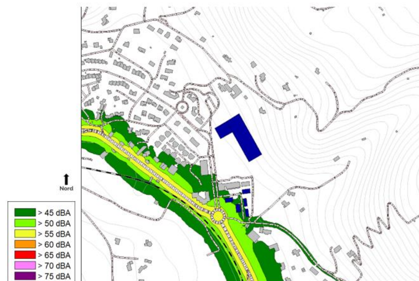
Figure 159 : Cartographie sonore en dBA à 4m au-dessus du sol – Etat Futur AVEC PROJET – Période 22h-6h
