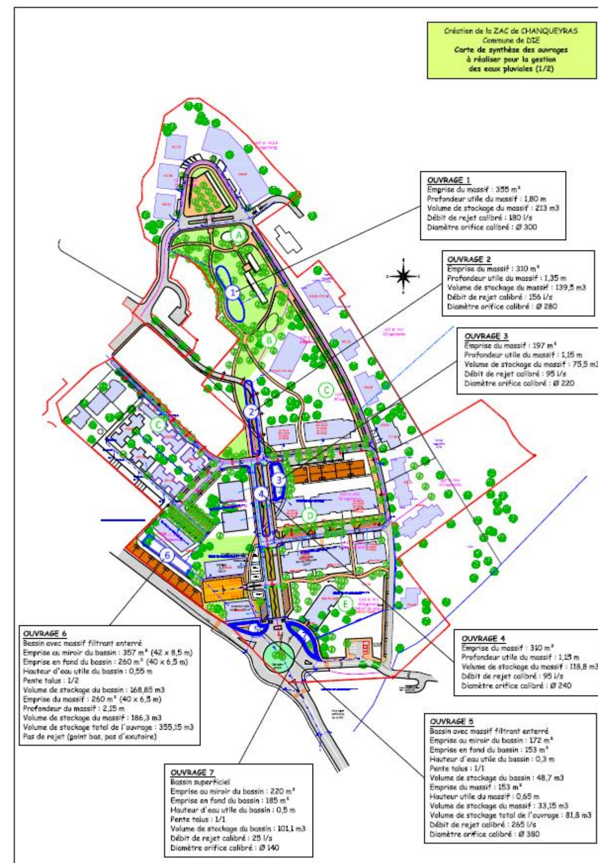
Figure 117 : Carte de synthèse des ouvrages de gestion de eaux pluviales 1/2 (source : DLE, 2013), plan masse non actualisé
