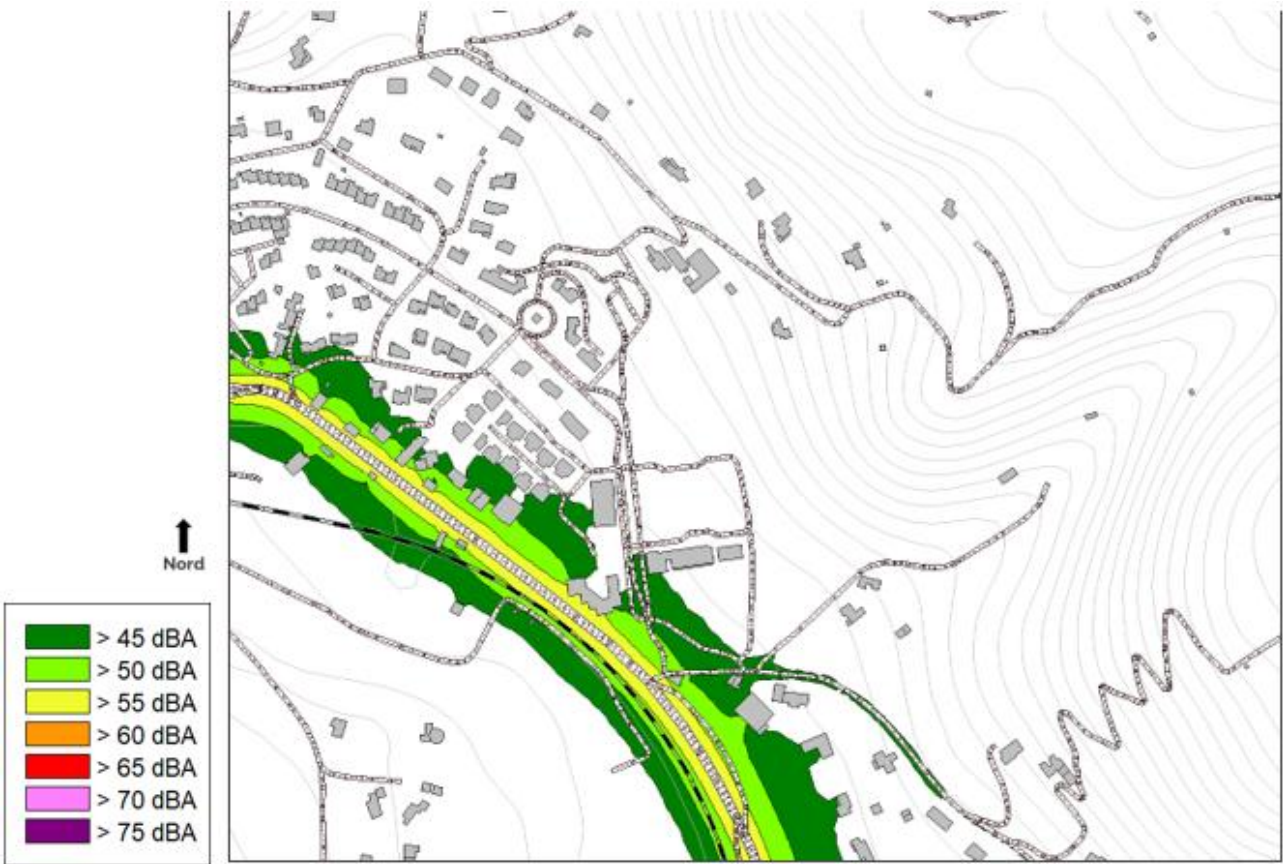
Figure 88 : Cartographie sonore en dBA à 4m au-dessus du sol – Etat initial – Période 22h-6h
